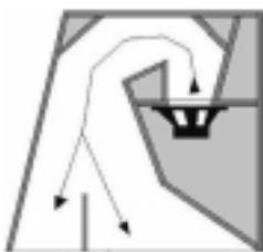
Рис. 14. Низкочастотный свернутый рупор
