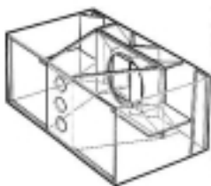
Рис. 16. Свернутый рупор с фазоинвертором
