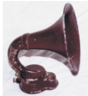
Рис. 2. Рупор Н.4 компании S.G. Brown (Британия)
